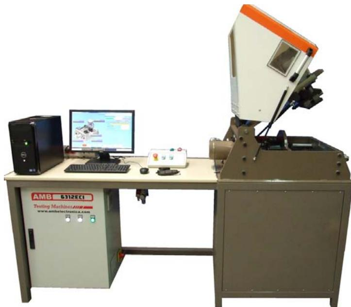
La máquina **AMB-6312-ECI** mide la resistencia de la unión entre el material de fricción y su soporte en pastillas de freno de disco y zapatas de freno de tambor, según la norma **ISO 6312:2001**.
