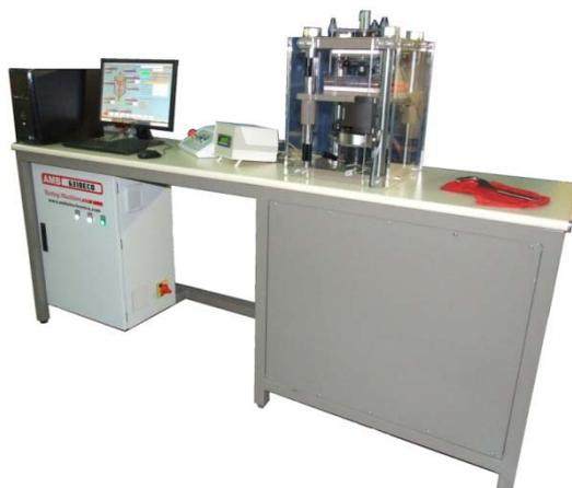
La máquina **AMB-6310-ECO** mide la deformación por compresión en pastillas de freno de disco y muestras de material de fricción, debido a la carga y la temperatura, según la norma **ISO 6310:2009**.
