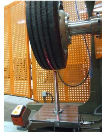
La máquina **AMB-1500-PBU** está compuesta por dos módulos de trabajo desarrollados para ensayar neumáticos según las normativas americanas **FMVSS 109, 119 y 139**.
