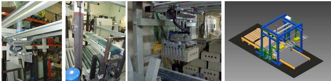
La máquina **AMB-PAL12** es un robot manipulador de 3 ejes, que permite paletizar de forma automática bloques extrusionados.
